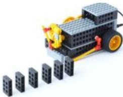
ドミノを並べる車型のロボットです。ギアの回転運動をビームを押し出す横方向の往復運動に変えてドミノを並べることができます。自動で定期的にドミノを並べる機構に注目して理解を深めます。
