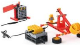
バッターはピッチャーが球を投げたことを感知し、自動的にバットを振ることができます。さらにプログラミングによりピッチャーが投げた音に反応してバットを振るように改造します。
