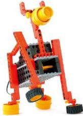
4本の足の出るタイミングを変えることで、本物の馬のように歩くことができるロボットです。頭の高さや足の長さなどを変えながら、安定して歩くロボットを作るためのバランスを学びます。
