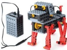
愛着がわく犬型ロボットです。よくしつけられた犬のように口元に触れると止まる仕組みを、タッチセンサーを利用して作ります。犬の足の動きが「リンク機構」により作り出されていることも学習します。
