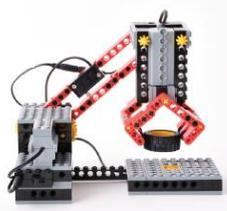
台に取り付けられた光センサーが物を感じし「つかむ」「運ぶ」「離す」という一連の動作を実行するロボットです。物をつかみ続けるための工夫や離す位置の調整により、確実に物を運ぶことができます。
