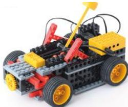
ステアリング（車の向きを変える仕組み）があるロボットです。ジョイント部分（ハンドルの動きを前輪部分に伝える部分）と車体の先端のピニオンギアとラックギアのかみ合わせがポイントです。
