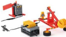
バッターはピッチャーが球を投げたことを感知し、自動的にバットを振ることができます。さらにプログラミングによりピッチャーが投げた音に反応してバットを振るように改造します。
