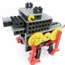
足にリンク機構を使っている犬型ロボットです。体の外に取り付けられたギアの組み合わせによって生まれる回転運動が、足を動かす運動に変わります。足の取り付け位置を変えて進み方の変化も観察します。
