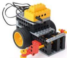
壁に沿って動くロボットです。コーナーでは、壁から離れた時にギアの組み合わせが変わって曲がり、また壁に沿って動きます。ガイドバーがうまく働くように、輪ゴムのかけ方を調整します。
