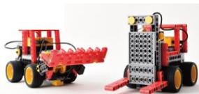
後半となる7月はプログラミングと動作検証を行います。フォーク部分の上げ下げ、前後移動の停止位置をタッチスイッチや光センサーで感知、制御し、自動で荷物を運搬できるようにプログラミングします。
