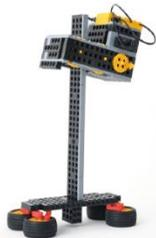
タッチセンサー黒を利用して自動停止型エレベーターを作ります。また上昇下降の時間に着目してパワーについて学びます。さらにプログラミングにより音を検知して上下に動くようにも改造します。
