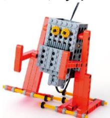
相撲を取る2足歩行ロボットです。足の動きに連動して手を動かしながら前に進みます。モーターの位置を工夫して重心を低くしたり、足裏の構造を工夫したりして相撲に強いロボットに改造していきます。
