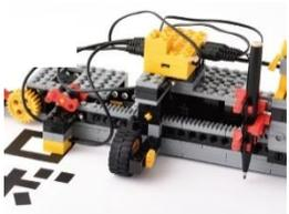
白黒の文字を光センサーで読み取り、タッチスイッチとモーターを連動させながら文字をコピーするロボットです。ラチェット機構を組み込むことにより、自動で少しずつ移動しながら、文字を走査します。
