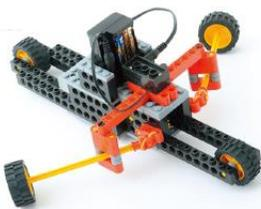
モーターの力で左右のオールを漕ぎながら前に進むボート型のロボットです。ギアのかみ合せを工夫して「てこの原理」を利用することで、オールを漕ぐスピードをゆったりとさせています。
