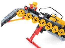
乗り物がモーターの力で一番高い位置まで持ち上げられ、一気に斜面を駆け下りるジェットコースター型ロボットです。斜面の角度を変えながら位置エネルギーと運動エネルギーの関係を理解します。
