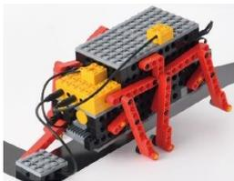
6本の脚で力強く前進するロボットです。足の動きに着目し、4本から6本に脚を増やす改造を進めながら、ロボットがスムーズに前進したり、歩く向きを変えたりする仕組みを観察します。
