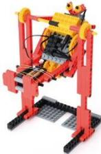
鉄棒でさか上がりができるロボットです。「ラチェット」という機構を使うことで、回転軸に対し滑らないように本体を持ち上げ、さか上りをします。ラチェットが一方方向のみに作用する仕組みを考えます。
