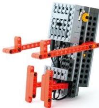
ロッドがロボットの本体を持ち上げ、頭から前転します。でんぐり返りの腕の回るスピードを作りだすギアの組み方や、スライドスイッチをどちらに動かすとうまく回転するのかを観察します。
