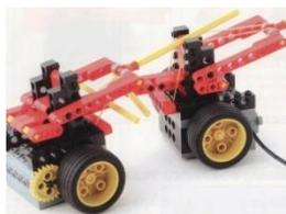
剣道の動きをするロボットです。相手に近くと自動的に竹刀を振り下ろします。モーターが一つしかないので、竹刀を振り下ろす仕組みは輪ゴムとロック機構を使います。無敵の剣士を目指しましょう！
