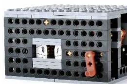
足し算、かけ算ができるロボットです。4種類のギアを試行錯誤しながら組み合わせ、10進法のしくみを利用して、2ケタの数字を表示できるように改造を進めます。計算のプログラムを作成しながら10進法の理解を深めます。
