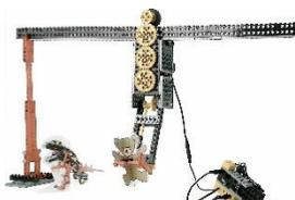
モーターの正転・逆転だけで、「レールの上を移動する」、「ものをつかむ」、「ものをはなす」という動作を行うロボットです。プログラミングでは声に反応してつかんだりはなしたりできるように改造します。
