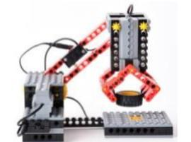
台に取り付けられた光センサーが物を感知し「つかむ」「運ぶ」「離す」という一連の動作を実行するロボットです。物をつかみ続けるための工夫や離す位置の調整により、確実に物を運ぶことができます。
