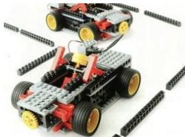
ステアリング（車の向きを変える仕組み）があるロボットです。ジョイント部分（ハンドルの動きを前輪部分に伝える部分）と車体の先端のピニオンギアとラックギアのかみ合わせがポイントです。
