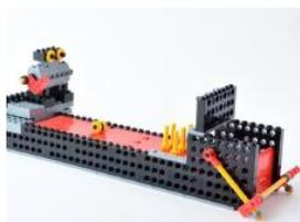
ロボットに直接接続されたLロッドを回転させて球を投げ、ピンを倒す本格的なボウリングゲームが楽しめます。倒れたピンを手軽に回収できる機構が付いているのもポイントのひとつです。
