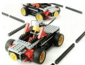
ステアリング(車の向きを変える仕組み)があるロボットです。ジョイント部分(ハンドルの動きを前輪部分に伝える部分)と車体の先端のピニオンギアとラックギアのかみ合わせがポイントです。
