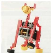
4本の足の出るタイミングを変えることで、本物の馬のように歩くことができるロボットです。頭の高さや足の長さなどを変えながら、安定して歩くロボットを作るためのバランスを学びます。
