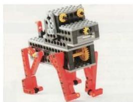
愛着がわく動きの犬型ロボットです。よくしつけられた犬のように口元に触れると止まる仕組みを、タッチセンサー黒を利用して作ります。犬の足の動きが「リンク機構」により作り出されていることも学習し
