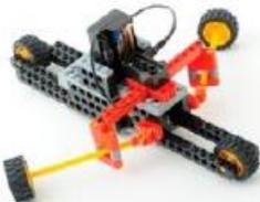
モーターの力で左右のオールを漕ぎながら前に進むボート型のロボットです。
