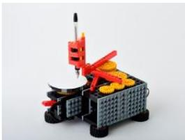
二体の親子ロボットの距離が伸びたり縮んだりしながら前に進むロボットです。クランクの動きやラチェットの動きについて学びます。タイヤを一方方向にのみ回転できるように改造します。
