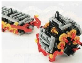
地面を進むムシ型ロボットです。スイッチを反対に入れると、ラチェットの動きでダンゴムシのように体を丸め変形します。変形してもギア同士がかみあったままになるように工夫されています。
