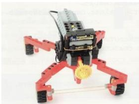
キャスター付きのX型の足が開閉することで車輪を直接駆動することなく前進するロボットです。なぜ足を開閉するだけでロボットが前進するのか、その仕組みを観察し、考えさせます。
