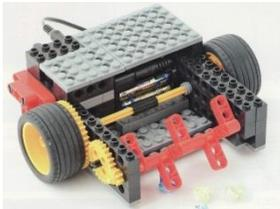
側面のギアの組み合わせにより、ロボットが進む速さと、掃除口の回転スピードが調整されてゴミを取り込む仕組みになっています。本体を傾けたりゴミが落ちないように壁をつくるなどの工夫も学びます。
