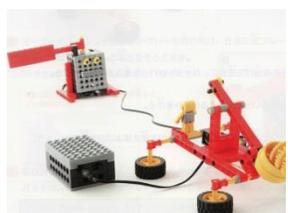
ピッチャーは輪ゴムの力でボールを投げ、バッターはモーターの回転でバットを振ります。そして、2 つのタッチセンサーを組み合わせ、ピッチャーとバッターの動きを連動させます。
