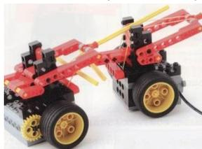
剣道の動きをするロボットです。相手に近づくと自動的に竹刀を振り下ろします。モーターが一つしかないので、竹刀を振り下ろす仕組みは輪ゴムとロック機構を使います。無敵の剣士を目指しましょう!
