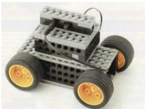
今回のロボットは、壁などに衝突すると反対方向へ進みます。衝突を検知する仕組みを取り入れた、自動走行する自動車です。ロッドの組み合わせにより、スライド式の自動スイッチを製作します。
