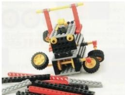
車輪を足に付け替えるだけで、四輪車からがたとと動くロボットへと変身していく面白さが体感できます。この変身は T ジョイントを使ってタイヤの取り付け方を変えることで可能になっています。
